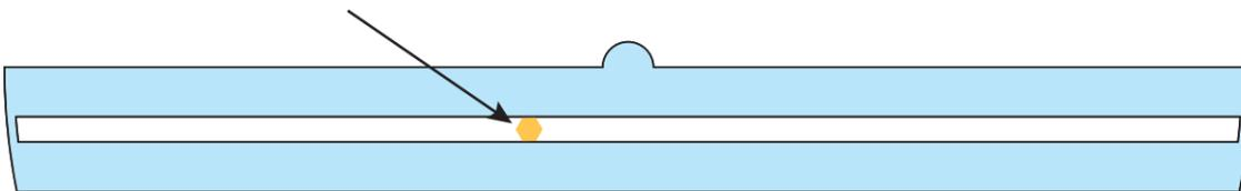
INSTALLER LE CURSEUR EN FAISANT PASSER LA VIS LAITON DE LA RÈGLE INFÉRIEURE DANS LE TROU DE LA PLAQUE
